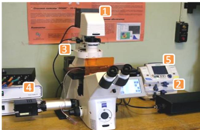
Рис. 21. Фотография экспериментальной установки для проведения micro-PIV измерений.
