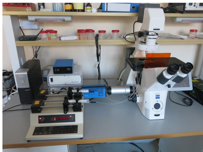
Рис. 54. Схема (слева) и фотография (справа) экспериментальной установки для визуализации режимов течения несмешивающихся жидкостей.
