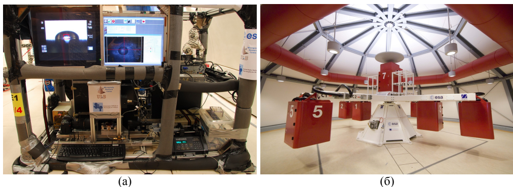
Рис. 19. (а) Экспериментальная установка для параболических полетов. (б) Центрифуга Европейского Космического Агентства.
