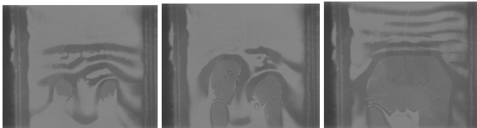
Рис. 9. Кризис на гладком нагревателе ( Re_L=15 , Re_G=200 , Q_{CHF}=15.7 \text{ Вт/см}^2 )
