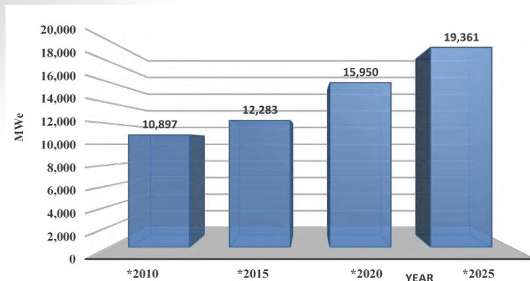
Установленная электрическая **мощность** геотермальных станций в мире с 2010 по 2025 гг.
