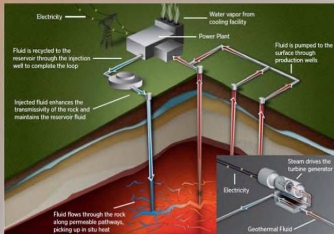
Схема утилизации глубинного тепла (EGS).
