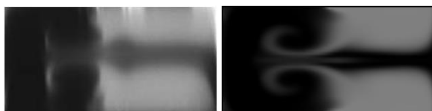
Рис. 1.26 – Распределение концентрации краски в поперечном сечении и различных отношений расходов. Здесь (а) – эксперимент [11, 23], (б) – результаты моделирования, Re = 186
