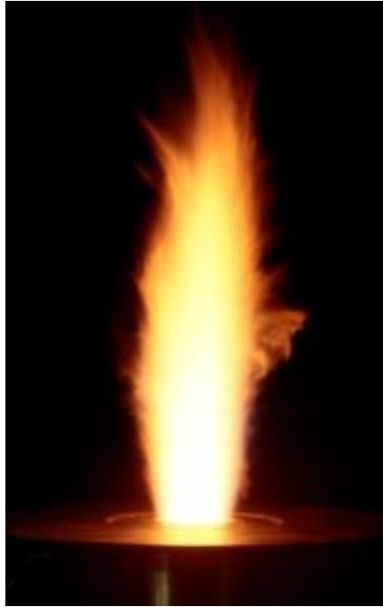
Рисунок 8. Визуализация проскока пламени внутрь камеры (аварийный режим работы).
