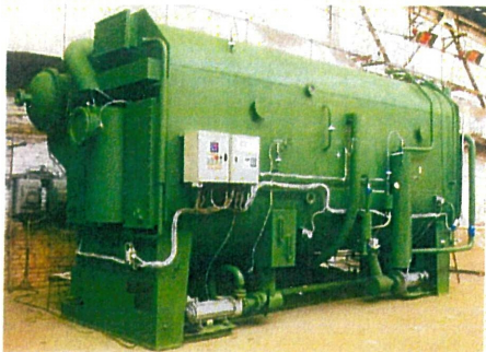
Холодильная машина с паровым обогревом с двухступенчатой регенерацией раствора АБХМ2-3000П мощностью 3000 кВт из поставки на Калининскую атомную электростанцию
