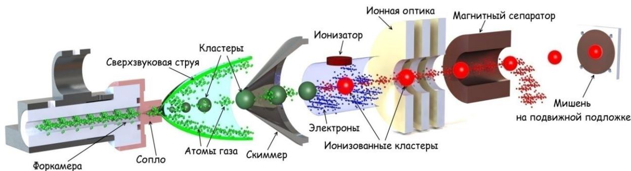
Рис. 3. Общая схема формирования ионно-кластерного пучка.
