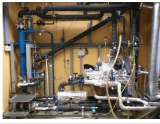
Стенд для исследований макетов теплообменников установки ОЦР. Лаборатория МНИЛ ЗАО НПВП «Турбокон», г. Калуга
